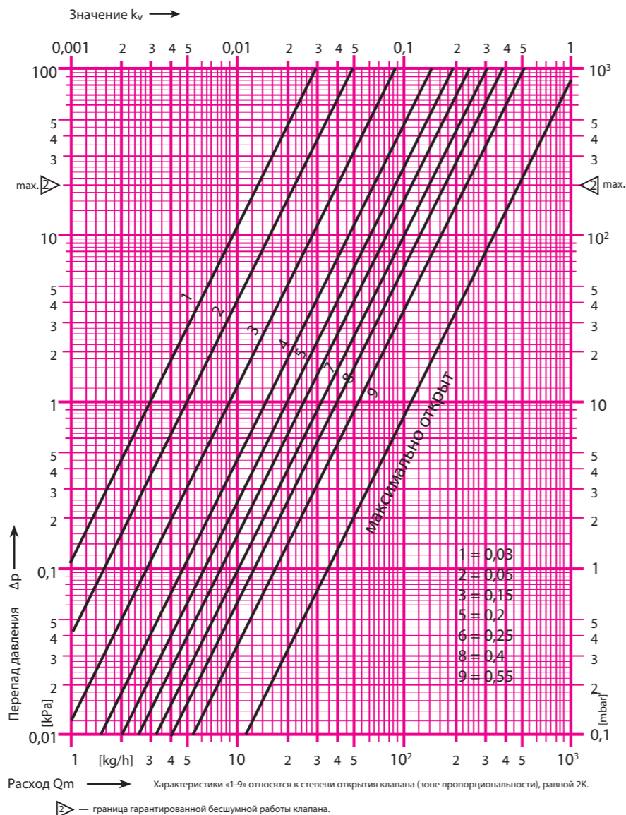
Рис. 5. Гидравлические характеристики терморегулирующей арматуры Herz
